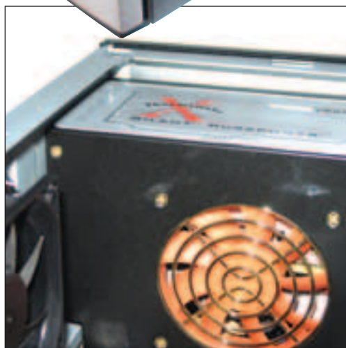
ЗА КАЧЕСТВЕННОЕ ЭНЕРГОСНАБЖЕНИЕ В НЕОРС ОТВЕЧАЕТ БЛОК ПИТАНИЯ XASERIII SILENT PUREPOWER 480W W0010 ОТ КОМПАНИИ THERMALTAKE.
