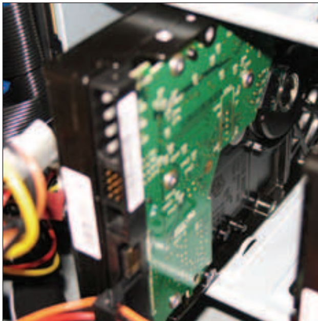
ПАРА ЖЕСТКИХ ДИСКОВ WESTERN DIGITAL WD1200JS ПОМОГУТ УСКОРИТЬ ЗАГРУЗКУ УРОВНЕЙ В ИГРЕ (RAID 0) ИЛИ ПОВЫСИТЬ НАДЕЖНОСТЬ ХРАНЕНИЯ ИНФОРМАЦИИ (RAID 1).
