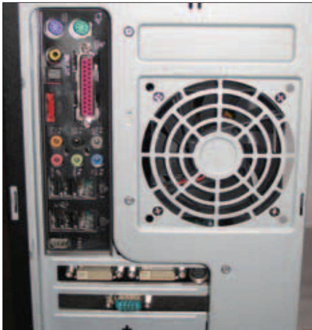
НА ЗАДНЕЙ СТЕНКЕ ЕСТЬ ТАКЖЕ РАЗЪЕМЫ ВСТРОЕННОГО 7.1-КАНАЛЬНОГО ЗВУКОВОГО КОНТРОЛЛЕРА REALTEK AVANCE LOGIC ALC850.
