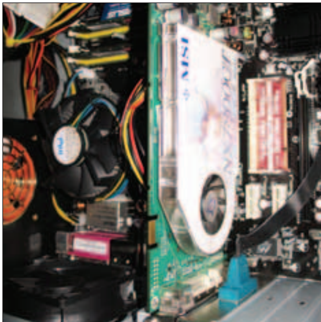
ВИДЕОКАРТА MSI NX7800GT-VT2D256E – ЭТО ОТЛИЧНАЯ СКОРОСТЬ В БОЛЬШИНСТВЕ СОВРЕМЕННЫХ ИГР. ХОТЯ В МАТЕРИНСКУЮ ПЛАТУ ASUS – R5ND2-SLI МОЖНО УСТАНОВИТЬ ЕЩЕ ОДИН ТАКОЙ ЖЕ АДАПТЕР В РЕЖИМЕ SLI.
